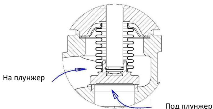
Перед пуском необходимо промыть систему водой при полностью открытом клапане чтобы удалить все элементы, которые могут повредить уплотнительное кольцо или клапан.
